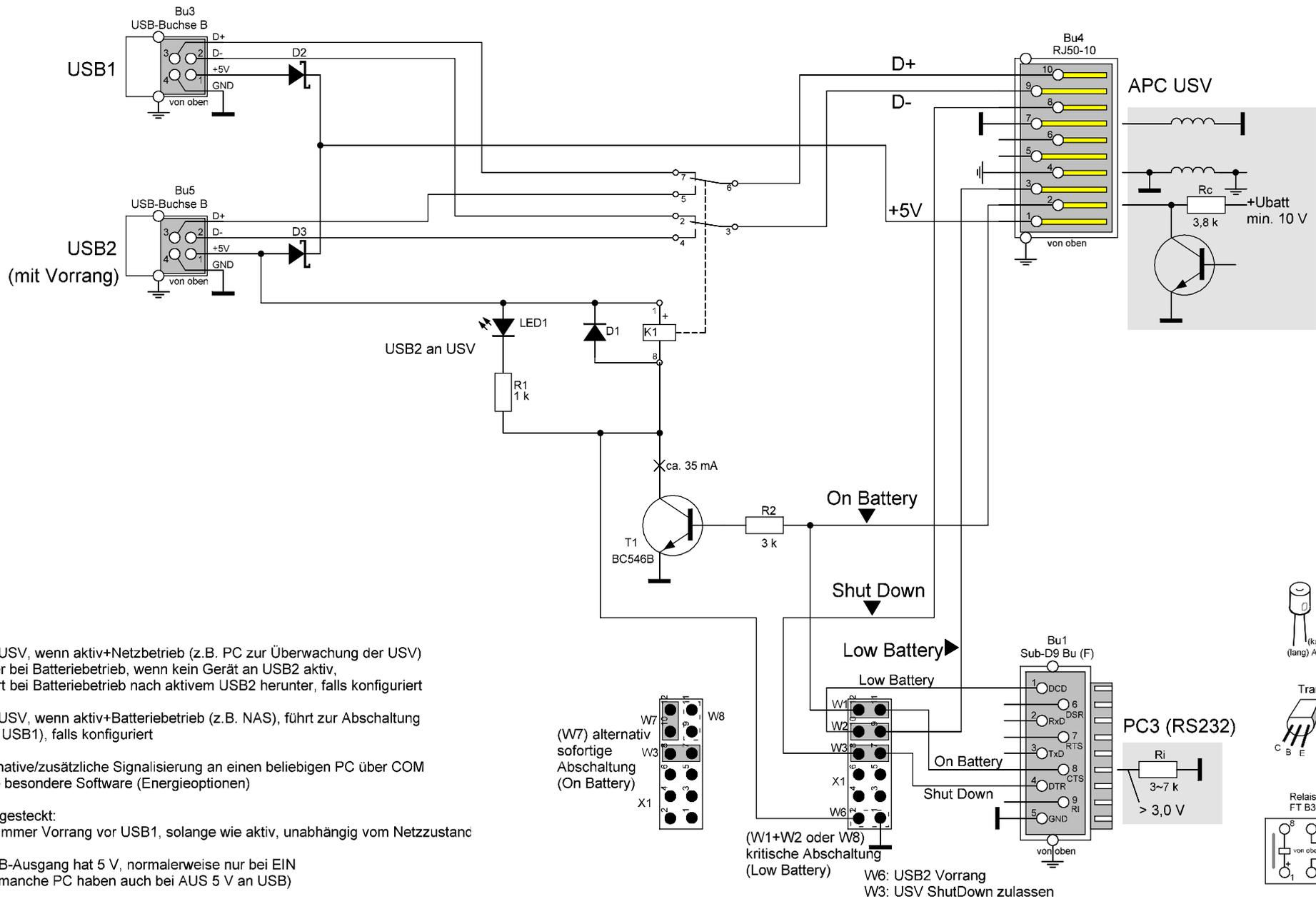
USB1: an USV, wenn aktiv+Netzbetrieb (z.B. PC zur Überwachung der USV) oder bei Batteriebetrieb, wenn kein Gerät an USB2 aktiv, fährt bei Batteriebetrieb nach aktivem USB2 herunter, falls konfiguriert
